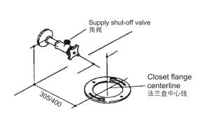
2. If replacing a toilet, remove the old wax. 如需拆除现有坐便器, 请先刮除旧的蜡环。
