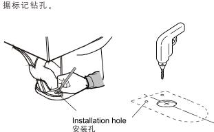
4. Install the flange. 将法兰套在缸体底部。
