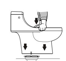
如图所示, 使用螺栓、垫圈和螺母将坐便器固定到
