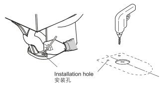
5. Install the flange. 将法兰套在缸体底部。
