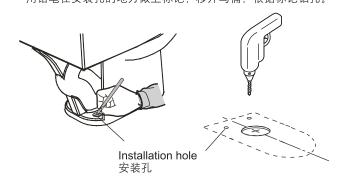
5. Install the flange. 将法兰套在缸体底部。
