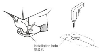
4. Install the flange. 将法兰套在缸体底部。
