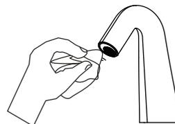
切勿使用擦洗剂或化学清洗剂（含氯的漂白剂）清洗龙头，因为这样清洗可能会导致龙头失去光泽，侵蚀电镀铬层或其它特殊处理的表面。
