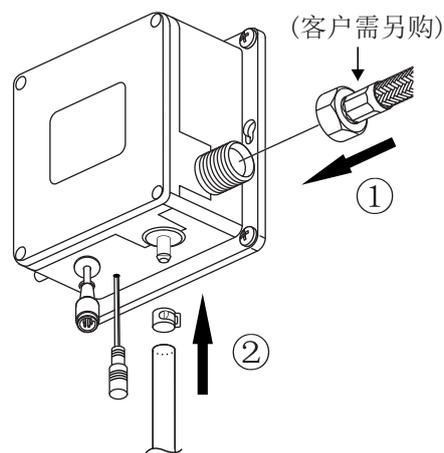
5. 将控制盒组件线与转接线连接好。①将连接后的转接线连接在控制阀组件上 ②将交流电源组件连接控制阀组件上 ③最后将交流电源组件插上电源。
