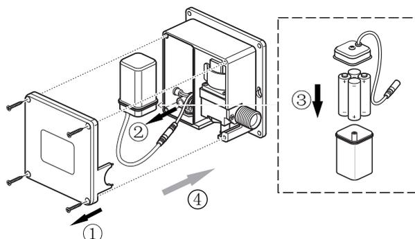
3. 在墙上钻孔安装控制阀组件。
