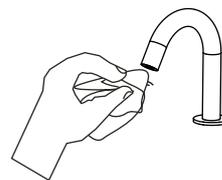
切勿使用擦洗剂或化学清洗剂（含氯的漂白剂）清洗龙头，因为这样清洗可能会导致龙头失去光泽，侵蚀电镀铬层或其它特殊处理的表面。
