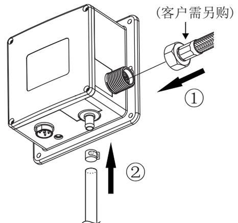
5. 将转接线与控制阀组件连接，插上电源，安装完毕后，按下控制阀组件调节按钮即可。
