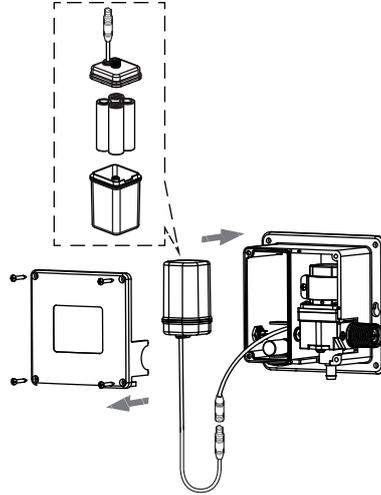
3. 在台盆下墙壁钻孔，将控制阀组件安装在台盆下墙壁。
