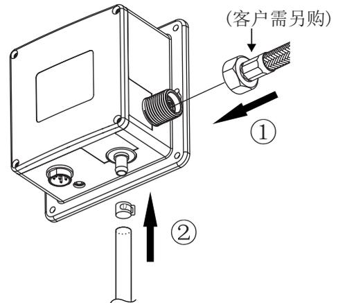
5. 将转接线与控制阀组件连接，插上电源，安装完毕后，按下控制阀组件调节按钮即可。
