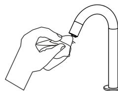
切勿使用擦洗剂或化学清洗剂（含氯的漂白剂）清洗龙头，因为这样清洗可能会导致龙头失去光泽，侵蚀电镀铬层或其它特殊处理的表面。
